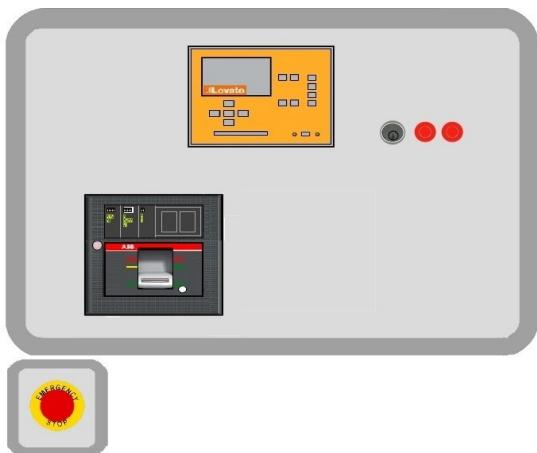
**Centralina di controllo LOVATO ELECTRIC RGK800 con multimetro (voltmetro, amperometro, frequenzimetro, contaore e voltmetro batteria). Indicazione della percentuale di carburante residua. Display LCD retroilluminato. Centralina espandibile con moduli di comunicazione dedicati e moduli di espansione per incrementare la funzionalità.**
