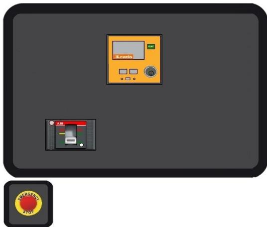
**Centralina di controllo LOVATO ELECTRIC RGK420 SA con multimetro (voltmetro, amperometro, frequenzimetro, contaore e voltmetro batteria).**
