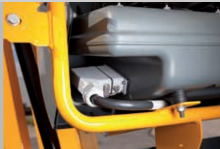
I connettori elettrici del quadro comandi in cesta sono facilmente inseribili e sono protetti dall'acqua
