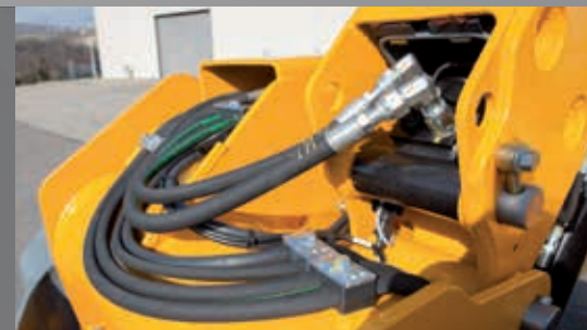
primo piano della rotazione idraulica del braccio
