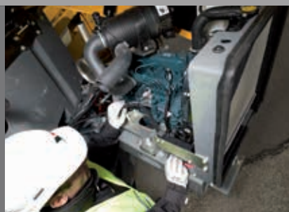
Il motore su supporto estraibile basculante permette accesso diretto ai componenti chiave
